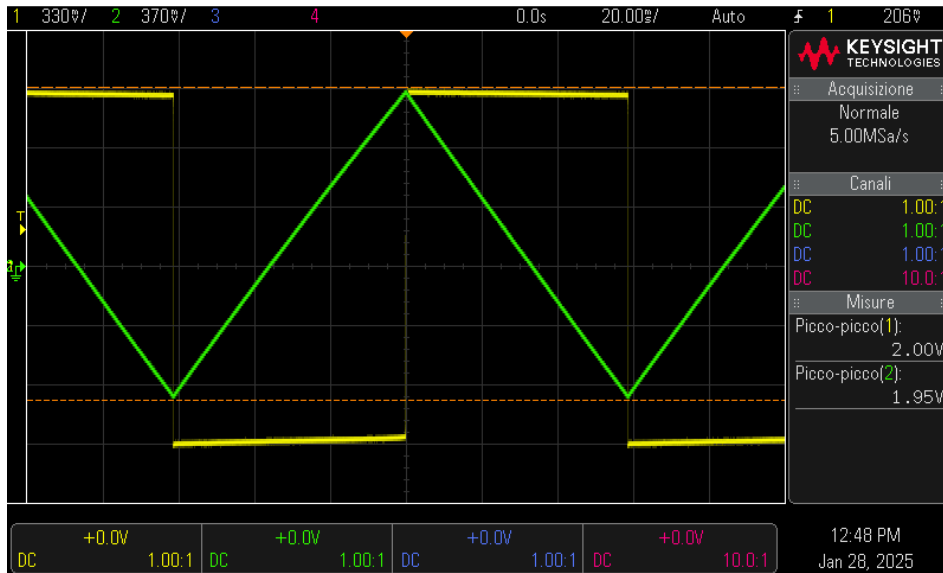
Figura 3.2.2. Segnali V_{tri} (verde) e V_{sq} (giallo). L'onda quadra subisce un abbassamento della sua ampiezza a causa della variazione della corrente nei diodi di clamp e di conseguenza la loro tensione V_d .
