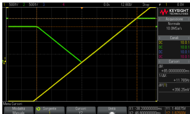
Figura 3.6.6. Caratteristica ingresso-uscita del rettificatore realizzato.
