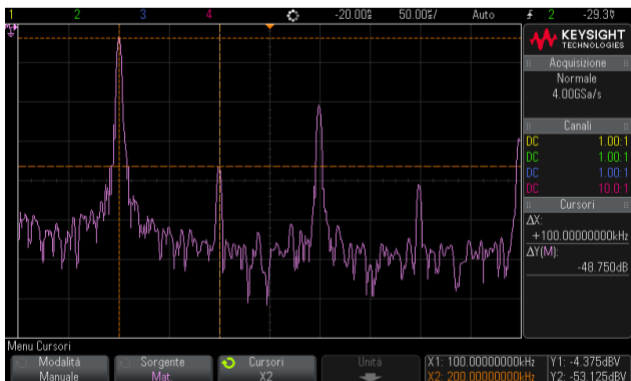
Figura 3.3.4. FFT dell'uscita del VCO in condizioni statiche. Scelti 100 kHz come banda massima in ingresso, le armoniche successive alla seconda non generano repliche spettrali che si sovrappongono alla banda del filtro BPF. La seconda armonica è l'unica a poter generare sovrapposizioni e si misura un contributo di -48 dB rispetto alla fondamentale.
