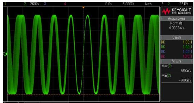
Figura 3.3.5. Uscita del VCO durante la modulazione in frequenza, si misura l'ampiezza picco-picco del segnale essere pari a 595 mV.
