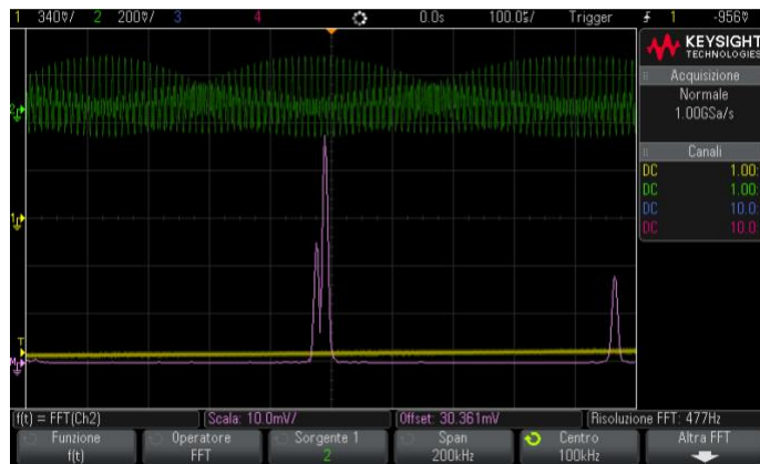
Figura 3.4.4. Uscita del moltiplicatore e relativa FFT, quando il feedthrough del segnale in ingresso approssima la replica in f_{vco}-f_{sig} si vedono i battimenti nell'uscita.
